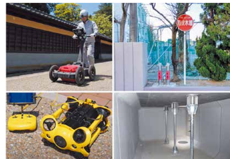
■ 防火水槽の調査・診断とメンテナンス
